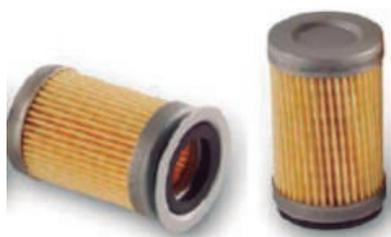
Cartucho filtrante compuesto por un muelle interior fabricado en acero galvanizado que soporta una estructura exterior de papel filtrante plisado y dos tapas de acero zincado encoladas con un adhesivo resistente a los derivados del petróleo.
